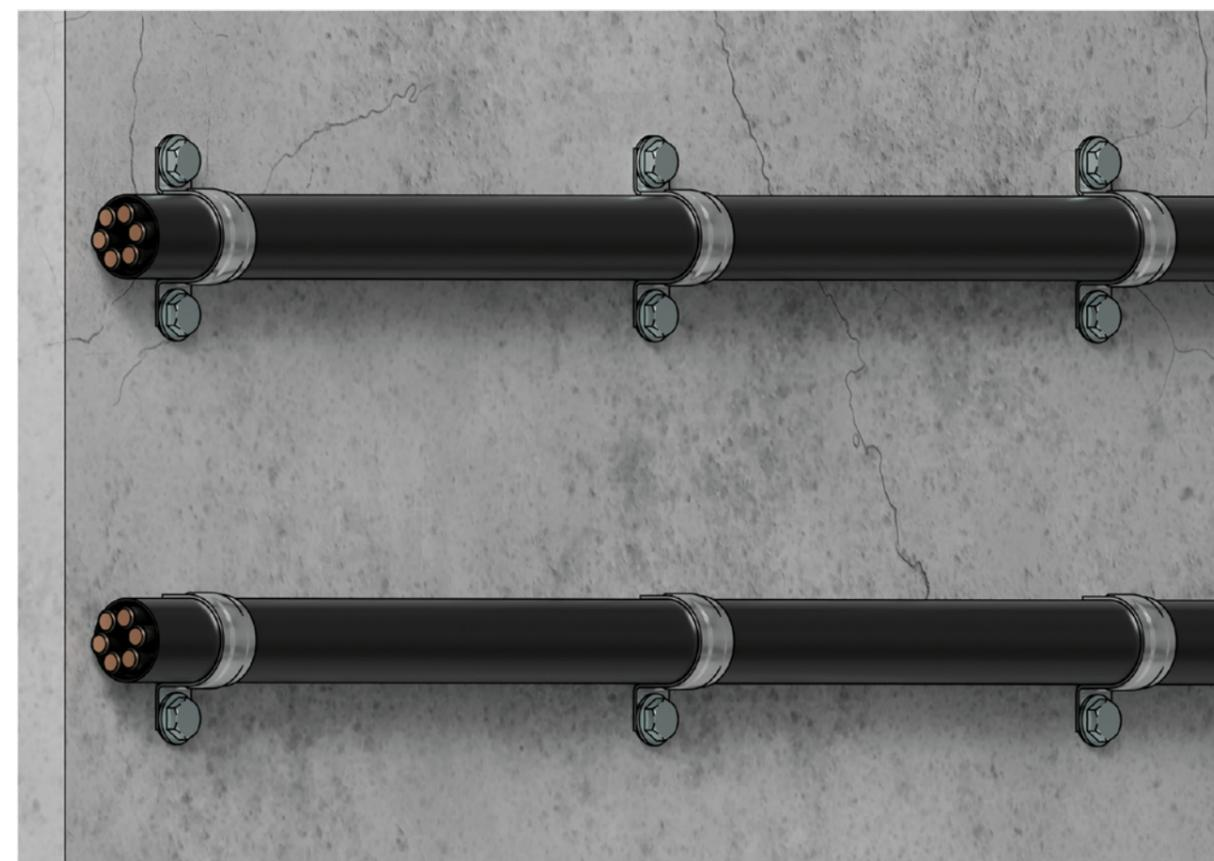
РИСУНОК 8. ОТКРЫТАЯ ПРОКЛАДКА КАБЕЛЯ ПРИ ПОМОЩИ ОДНОЛАПКОВЫХ/ДВУХЛАПКОВЫХ СКОБ
